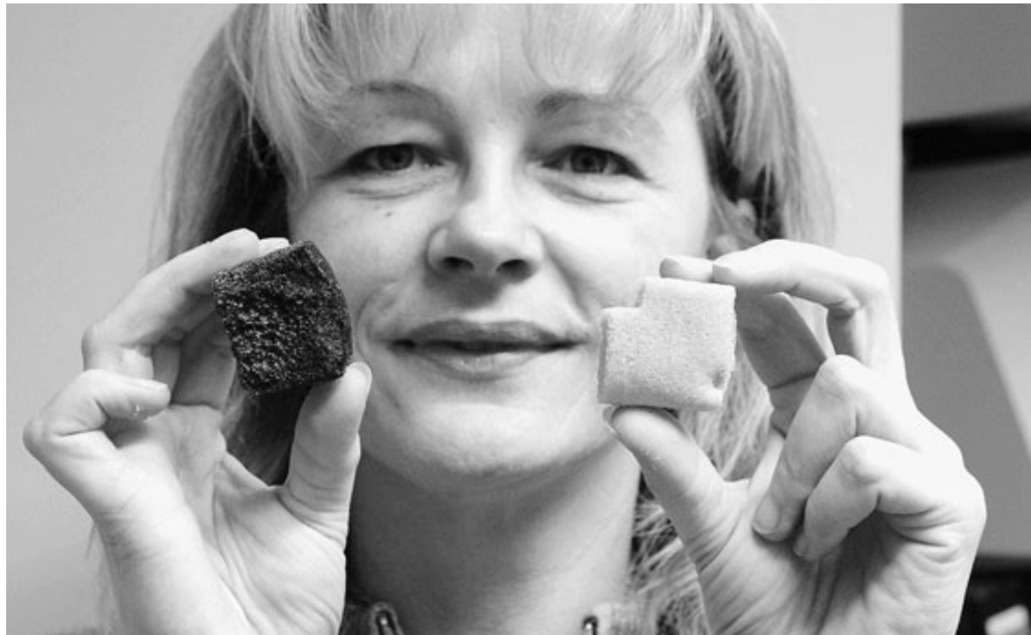
Die Chemikerin Dr. Michaela Wilhelm mit ihrem Forschungsgegenstand, den für Brennstoffzellen verwendeten metallhaltigen Polysiloxanen. Links ist der Werkstoff in der wärmebehandelten Form zu sehen, in der er für die Elektrokatalysatoren genutzt werden soll. FOTO: JOCHEN STOSS
